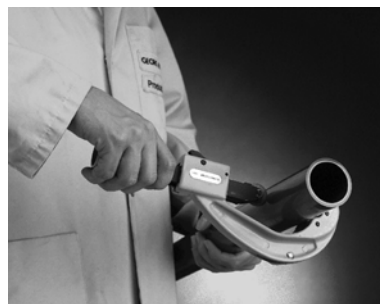
Отрезание трубы необходимой длины
